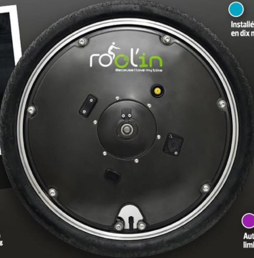
**CARACTÉRISTIQUES** • Moteur 24 V 250 W • Batterie Lithium-Ion 24 V, 6,6 à 9 Ah • Autonomie de 20 à 65 km • Poids de 6 à 8 kg • Taille 20, 26 ou 28 pouces • Vitesse (avec assistance électrique) 25 km/h
