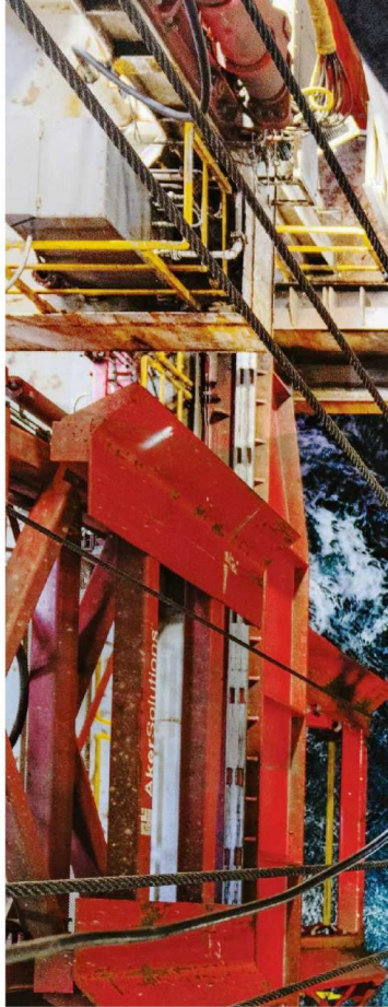
Une plateforme pétrolière, Transocean Enabler, procède à des forages d'injection de plus de 2 km sous le fond de la mer du Nord pour créer un réseau de réservoirs sous-marins pouvant absorber 1,5 million de tonnes de \text{CO}_2 par an.
