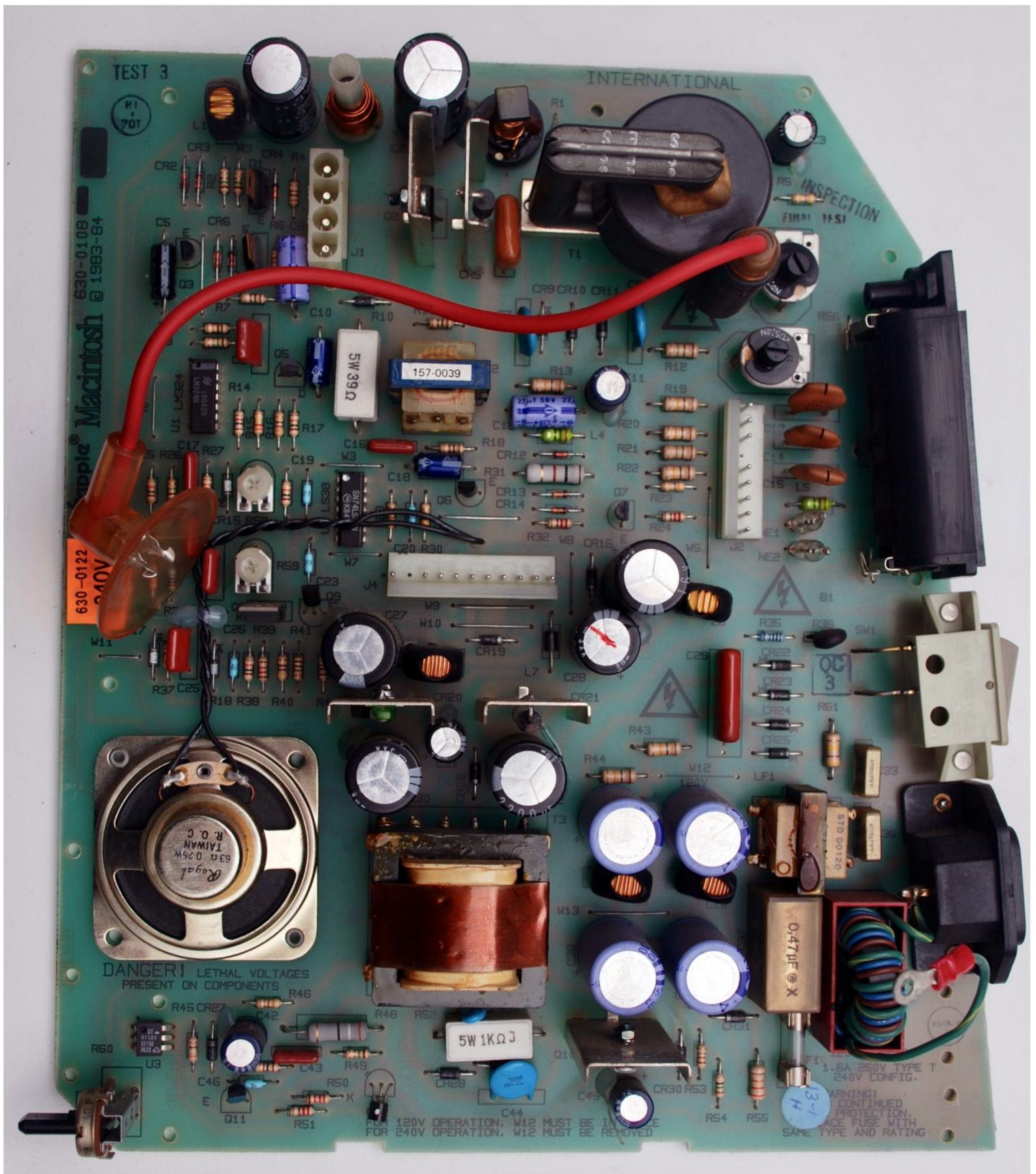
Carte analogique modèle international 1983-84 Pour tenir dans le boîtier et le design particulier de celui-ci, les ingénieurs déportent l'alimentation, le son et la vidéo sur cette carte verticale. Elle est prête à l'été 83 avec les ultimes modifications matérielles.
