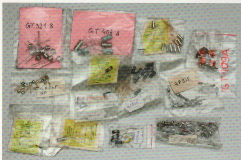
Figure 7 : D'autres transistors fournis par Jaromir, principalement de la série GC/GF/GT/NU, construits derrière le « Rideau de fer » par Tesla en Tchécoslovaquie. La variété de types, de performances, de tailles et de boîtiers est plus grande, probablement pour servir plus de clients que juste les militaires.
