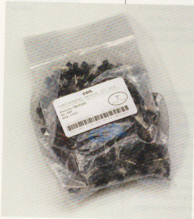
Figure 20 : De nos jours, un sachet de 1000 transistors au silicium (ici des BC559 : PNP - 30 V/100 mA/0,5 W/150 MHz, h_{fe}=100-800 ) coûte approximativement 15 €. Non seulement ils sont moins chers que le germanium, mais les caractéristiques sont meilleures, très stables en température, et varient très peu d'une pièce à l'autre. Vive la modernité !
