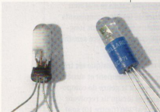
Figure 18 : Deux transistors quasiment identiques mais aux fonctions différentes : à gauche, l'OC71 est un transistor de préamplification basse fréquence que l'on ne veut pas sensible à la lumière, donc l'ampoule en verre est peinte en noir et remplie de gel silicone opaque. À droite, l'OCP71 a le même assemblage électronique dans un boîtier légèrement différent : le verre n'est pas peint et le silicone est clair pour laisser passer la lumière.
