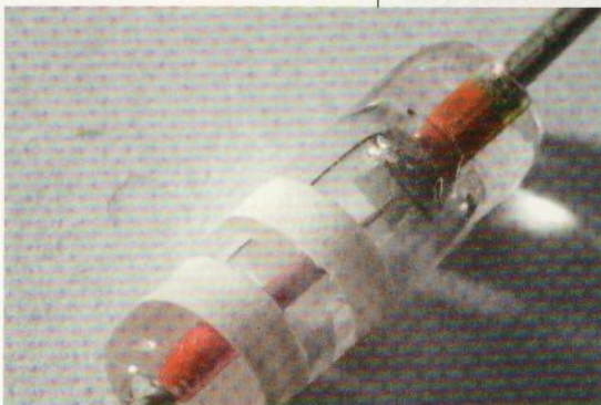
Figure 3 : Les diodes encapsulées dans du verre permettent d'observer la jonction entre le métal et le semi-conducteur. Ici, une diode russe Д9К laisse apercevoir la pointe métallique, tordue pour que le ressort appuie sur le fin carré de germanium. Ce dernier repose sur un point de soudure (brillant) faisant la liaison mécanique et électrique avec la cathode. La surface de contact microscopique explique pourquoi le courant est limité à 20 mA environ. Au-delà, la densité de courant au niveau de la pointe augmenterait dangereusement la température et endommagerait la jonction.
