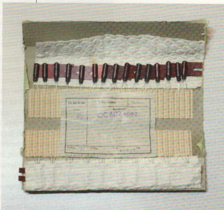
Figure 9 : La palme de l'emballage revient à Telefunken pour son sublime écrin en carton, papier ondulé et ouate de cellulose avec de jolis motifs en relief. Confortablement installés à la main, on y trouve 25 exemplaires d'OC602 : c'est un transistor « à alliage » d'amplification audio pour l'étage final (avant un petit haut-parleur) annoncé en 1954. Une languette en métal autour du corps en verre forme un petit radiateur à visser, ce qui permet de dépasser les 50 mW typiques du modèle standard (ici, c'est le modèle « spécial »). Pour le reste, c'est un PNP au germanium, 15 V 175 mW avec un gain d'environ 25 et un courant de fuite d'environ 10 \mu A (à froid !). Voir aussi https://sites.google.com/site/transistorhistory/Home/european-semiconductor-manufacturers/history-of-telefunken .
