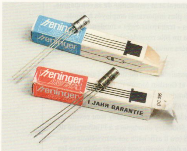
Figure 8 : Deux transistors OC305 emballés individuellement dans leur minuscule boîte en papier. Introduits en 1957 par Intermetall et fabriqués par ITT, 32 V 50 mA, f_t < 2 MHz. On ne voit plus un tel soin de nos jours, où les composants ne coûtent que quelques centimes et leurs emballages sont adaptés pour les machines automatisées. Je me demande si la garantie d'un an est encore valable... Origine : https://www.ebay.fr/str/germaniumtransistor .
