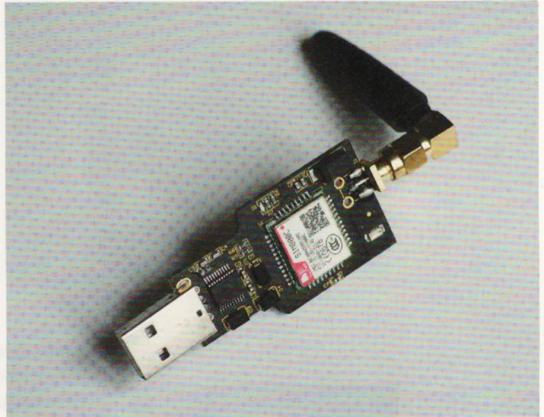
Figure 4 : Carte USB 2G GSM avec un emplacement pour une carte micro SIM.
