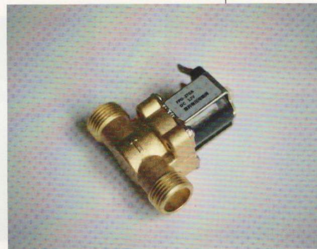
Figure 9 : Une électrovanne 1/2 pouces. Il suffit de la brancher derrière un transformateur 12 V pour qu'elle s'ouvre avec le courant, et coupe l'arrivée d'eau quand il n'y a plus d'électricité.
