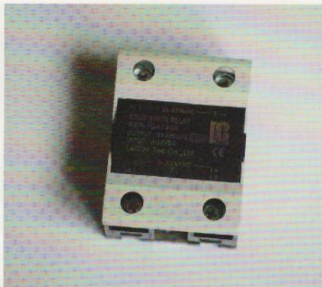
Figure 6 : Relais SSR, la commande se fait sur les bornes du bas 3 et 4 (0 ou 3 V continu, donné par le Raspberry Pi), et cela ferme le contact sur les bornes du haut (1 et 2) pour ce modèle qui est normalement ouvert.
