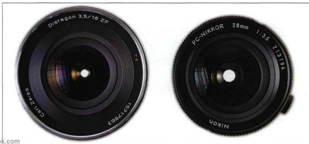
Ces deux objectifs possèdent la même ouverture maximale (f:3,5). Leur focale étant différente, le diamètre de leur pupille d'entrée n'est pas identique: 5,1 mm pour le 18 mm et 8,0 mm pour le 28 mm.
