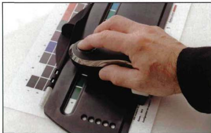
La lecture des échantillons de couleur est facilitée par le nouveau guide du spectrophotomètre. Les nouvelles chartes EZ comportent des échantillons de forme rectangulaire, qui permettent une lecture par bande. Les chartes "Expert", dont les échantillons sont carrés doivent être lus en mode ponctuel.
