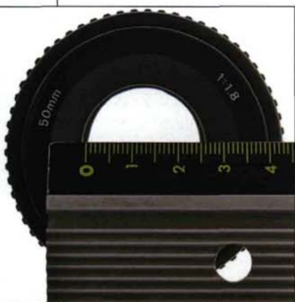
Dans cet objectif de focale égale à 50 mm, si on choisit l'ouverture f:2, on constate bien que le diamètre de la pupille d'entrée d est égal à 25 mm ( d = 50/2 ).
