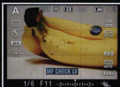
▲ Le nouveau mode MF Check Live View permet une visualisation 100 % via le capteur principal, mais ne permet pas la mise au point AF directe.
