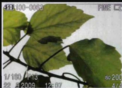
▲ Cette photo plein cadre de l'écran arrière montre la grande finesse d'affichage (270 dpi) de sa trame de 921 600 diodes R, V et B.
