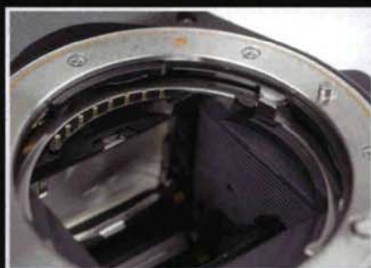
▲ L'Alpha 550 conserve un moteur interne pour l'entraînement de la mise au point et du diaphragme, ce qui augmente son poids.
