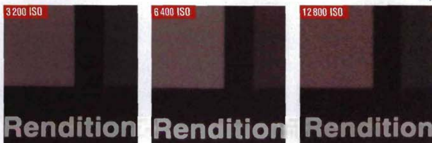
▲ Les plaques grises agrandies de la charte Gretag montrent que le bruit est très bien contenu jusqu'à 3200 ISO. Les sensibilités de 6400 et 12800 ISO, plus critiques, sont à réserver aux cas extrêmes.
