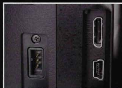
▲ Côté connectique, on a droit à une prise pour télécommande, et aux sorties USB et HDMI. La sortie vidéo VGA a été abandonnée.
