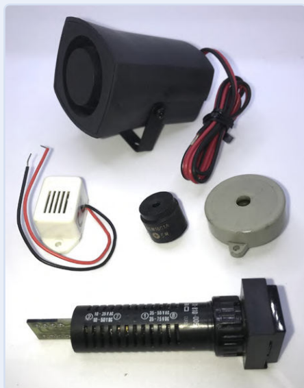
Figure 3. Divers buzzers piézo-électriques (beepers). Ils sont équipés d'un système électronique permettant de contrôler l'élément. À l'arrière : une sirène piézoélectrique de 12 V. Au centre : trois buzzers piézo différents. Avant : un buzzer piézoélectrique CA/CC destiné à être utilisé dans les tableaux de distribution industriels (adapté à plusieurs tensions).
