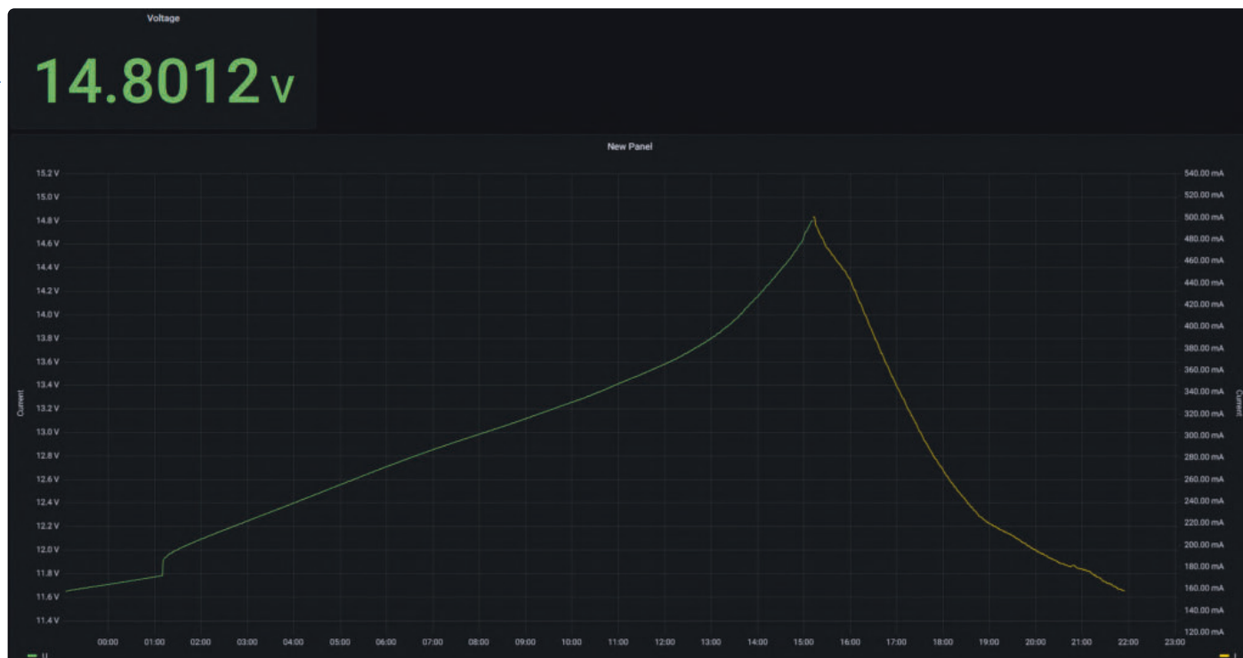
Figure 6. Tension (verte) et courant (jaune) de la batterie pendant la charge d'une batterie au plomb de 12 V, mesurés via un adaptateur ESP32/RS232.
