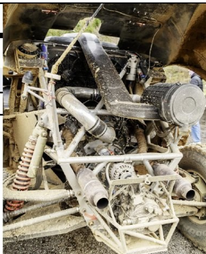
Notez le châssis multitubulaire, la boîte de vitesses située tout à l'arrière, ainsi que les amortisseurs XXL du spécialiste Bos.
