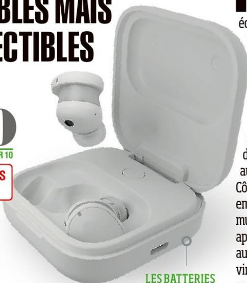
LES BATTERIES de l'étui et des écouteurs, remplaçables, favorisent un usage du produit sur le long terme.
