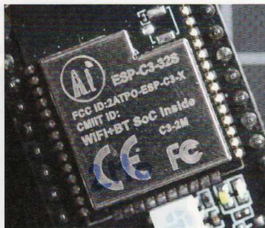
L'ESP32-C3 est l'un des premiers microcontrôleurs Espressif utilisant un cœur RISC-V.
