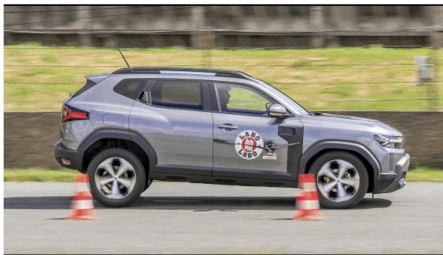
Doté de quatre freins à disques sur toutes les versions, le Duster affiche des distances d'arrêt dans la bonne moyenne de la catégorie, avec 64 m pour stopper depuis 130 km/h.
