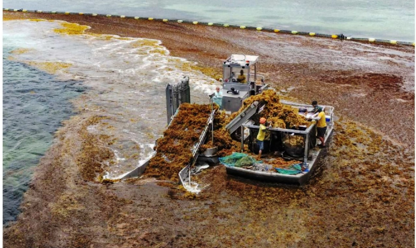
↑ Le bateau-tapis Sargator collecte les sargasses accumulées derrière un filet déviant au large du François, en Martinique.
