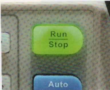
Fig. 3 : L'oscilloscope est en mode capture automatique en continu, le bouton est vert.
