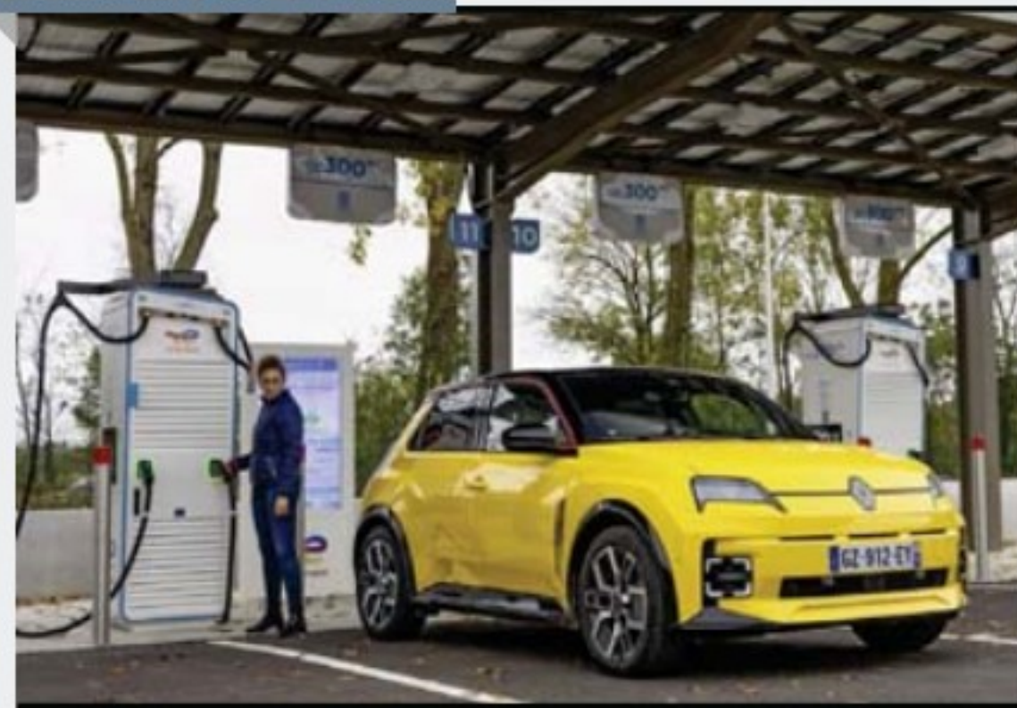
Capable de se recharger à une puissance allant jusqu'à 100 kW, la R5 demande environ 30 mn pour faire le "plein" de 15 à 80%. Correct.
