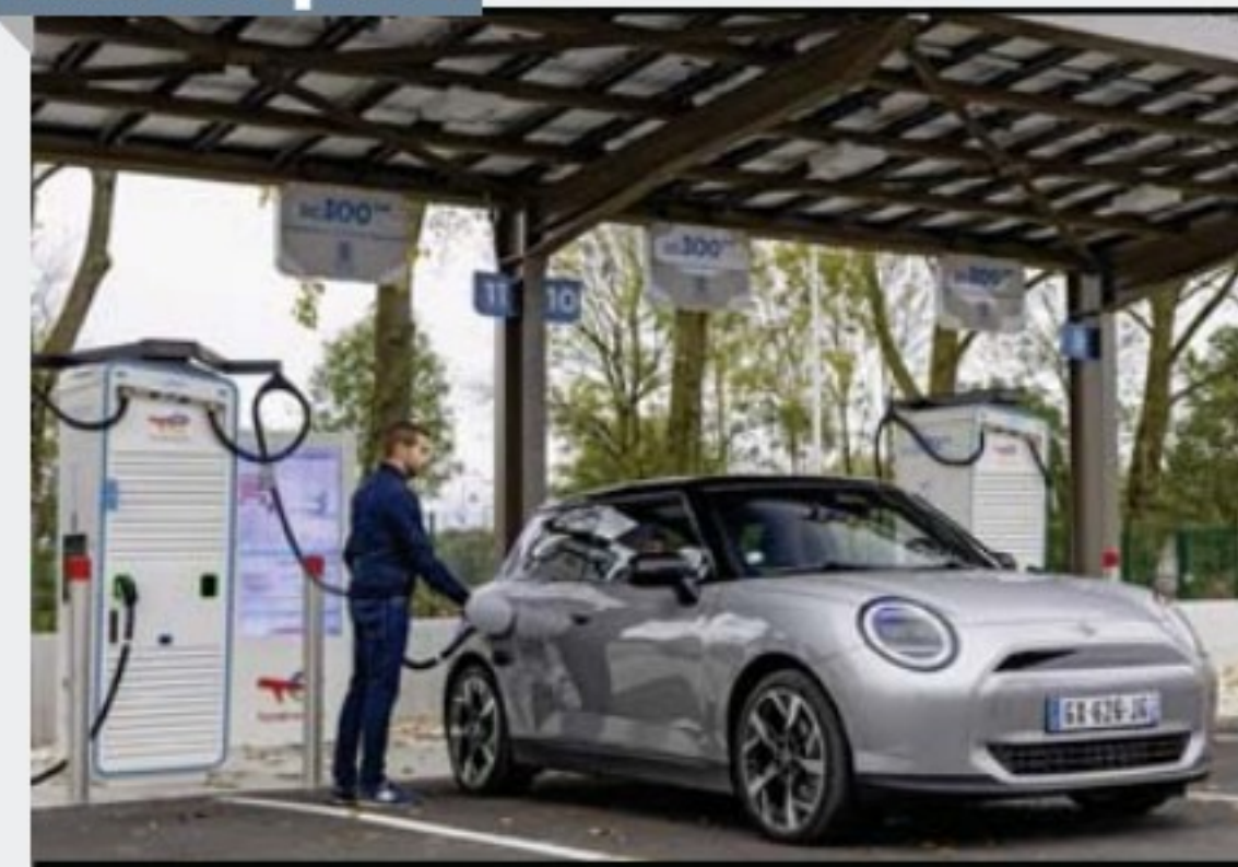
Certes, elle n'accepte que 70 kW de puissance maxi, mais sa batterie étant petite, la Mini se contente de 28 mn pour charger de 10 à 80%.
