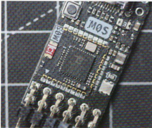
Ce microcontrôleur est le BL616 de Bouffalo Lab. Un cœur RISC-V RV32GCP à 320 MHz avec 480 Kio de SRAM, 4 Mio de flash, I2C, UART, SPI, Bluetooth 5.2, Wi-Fi 6 et USB HighSpeed OTG.
