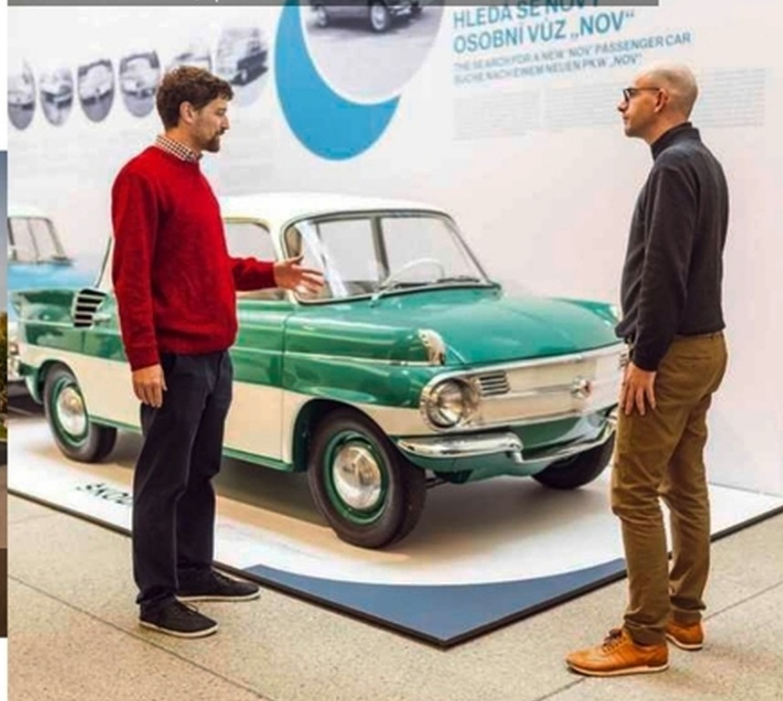
Ce prototype 988 préliminaire du projet 1000 MB surprend avec son nez très court, qui incarne son architecture à moteur arrière.
