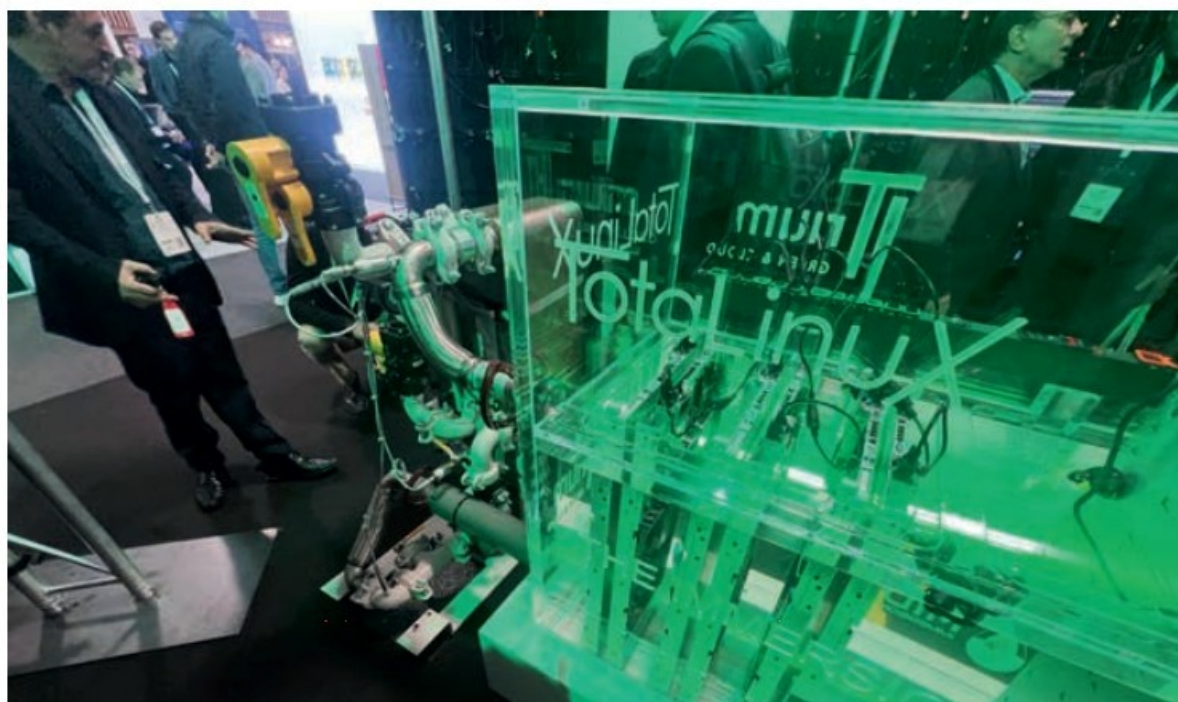
Présentée sur le salon, l'Immersion Cooling est une technologie innovante de refroidissement qui consiste à immerger les composants informatiques dans un liquide non conducteur.
