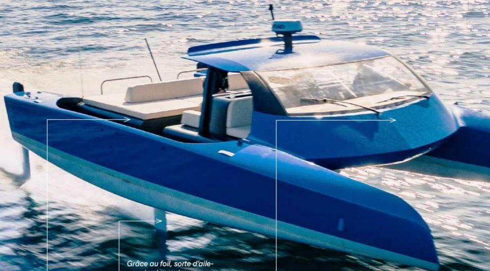
*Grâce au foil, sorte d'aileron placé sous les coques, le bateau se soulève pour gagner en vitesse et en confort de navigation.*
