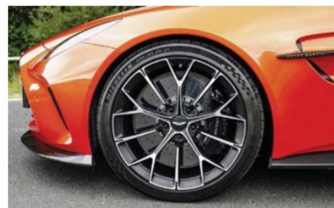
Les roues de 21" chaussent du 275 à l'avant et du 325 à l'arrière. Pas de demi-mesure!
