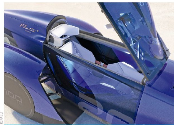
La verrière d'inspiration aéronautique dévoile un siège baquet conçu en toile tendue.
