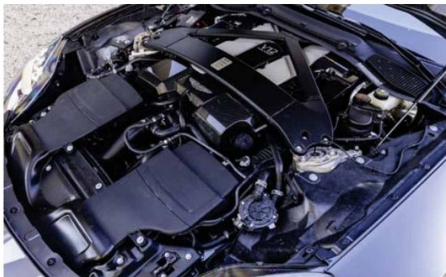
Sous le capot habillé de carbone, le V12 (en position centrale avant, au bénéfice de la répartition des masses) porte toujours la signature du technicien chargé de son contrôle final.
