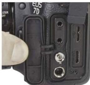
Derrière la double trappe, les connexions sont à l'abri de la poussière et de l'humidité. À noter, la prise USB3 et les deux prises vidéo (casque et micro). Une prise télécommande (type N3) y figure aussi.
