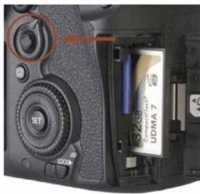
À l'arrière de l'appareil, on aperçoit le levier de sélection des modes de couplage des collimateurs AF. Le joystick en son centre permet, lui, de changer de collimateur ou de groupe de collimateurs.
