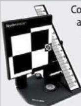
Conçu pour aider les photographes à corriger la mise au point automatique de leur appareil et de leurs différents objectifs AF, le SpyderLensCal fournit une méthode rapide et fiable pour étalonner facilement les objectifs interchangeables et les appareils photo numériques récents qui disposent d'une fonction d'étalonnage de l'autofocus : Canon (50D, 7D, 5DMkII, 1DMkIII, 1DMkIV, 1DsMkIII, 1DIV) Nikon (D300, D300s, D700, D3, D3s, D3x) Sony (A900, A850) Olympus (E-30, E-620) Pentax (K20D, K7D).
