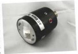
Le flash bulb Inter-Image est équipé d'une cellule sensible qui le déclenchera en synchronisation avec l'éclair d'un autre flash extérieur, mais il n'y a pas de réglage en mode pré éclairage. Si l'appareil est muni d'un système de pré flash, il faut, soit neutraliser le pré flash, soit utiliser le cordon synchro.
