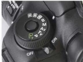
Le sélecteur de modes d'exposition comporte les classiques P, Av, Tv et M, ainsi que la pose B et trois modes Utilisateur (C1 à C3), qui sont facilement accessibles sur le terrain. Un verrou empêche la rotation accidentelle du sélecteur.
