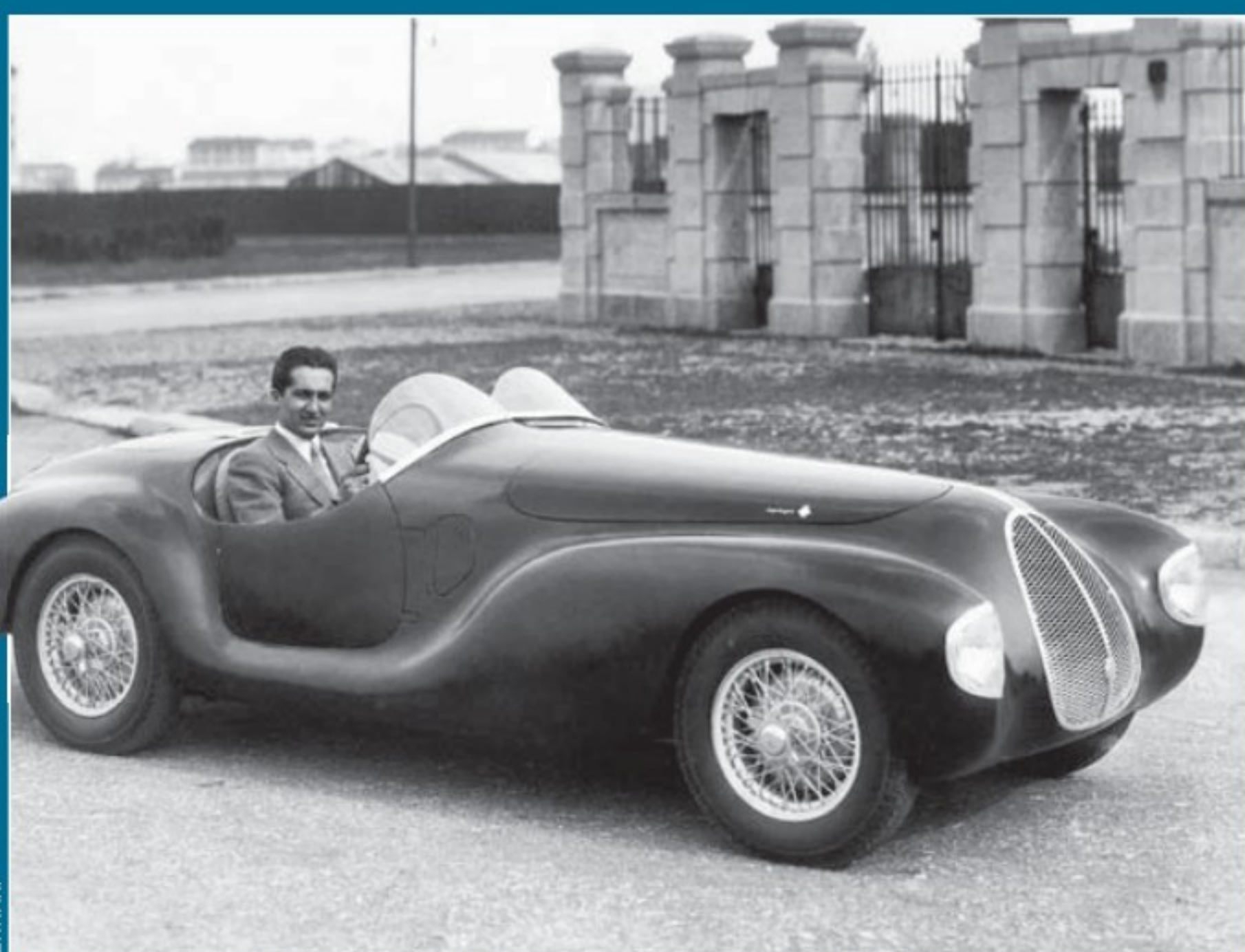
La Tipo 815, construite par Enzo en 1940 chez Auto Avio Costruzioni, peut être considérée comme la première vraie Ferrari de l'histoire. Sous le long capot, deux 4 cylindres d'origine Fiat accolés forment un 8 cylindres en ligne.
