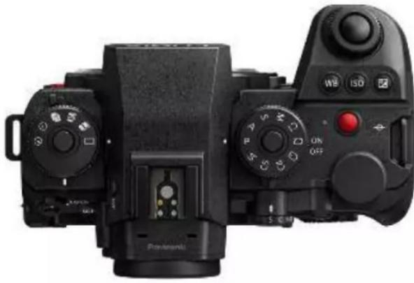
L'écran secondaire a été supprimé au profit sur l'épaule gauche d'une double molette pour le réglage des cadences sur sa partie supérieure et la configuration photo/vidéo sur le bas.
