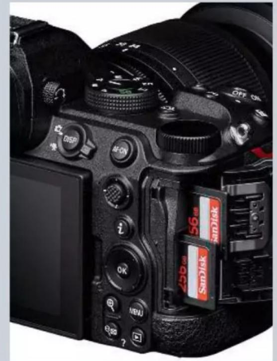
Comme sur le Z5, les deux logements pour carte mémoire sont au format SD UHS-II. Les Z6II et Z6III sont équipés d'un logement CFexpress et d'un logement SD, et le Z7 d'un SD et d'un microSD.
