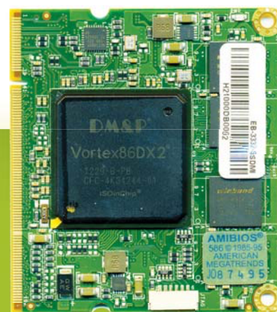
Le module amovible contient le SoC Vortex86DX2 à 933 MHz et 2 Go de DDR2.
