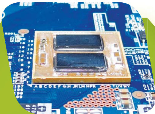
Le Nano X4 est constitué de deux dies Dual-Core.
