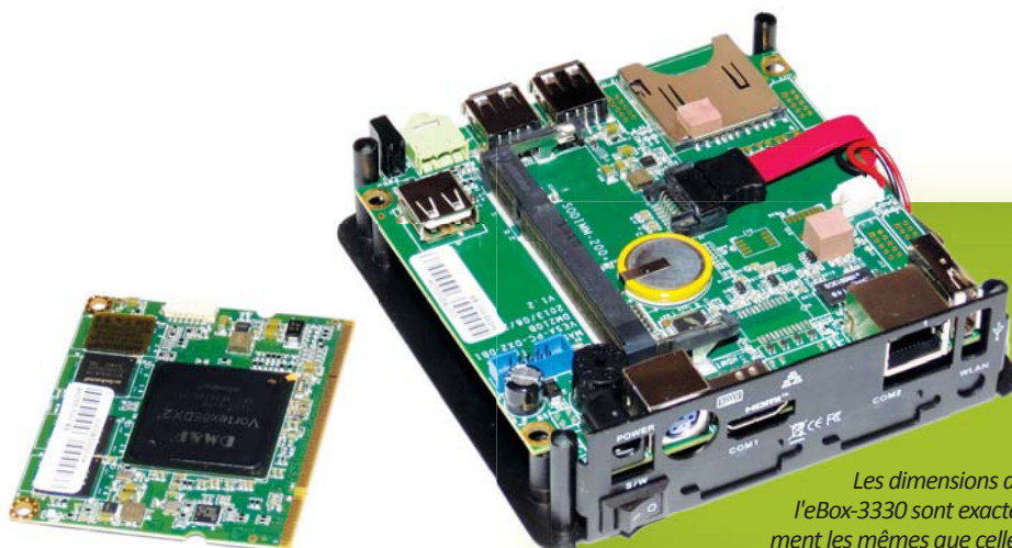
Le module amovible contient le SoC Vortex86DX2 à 933 MHz et 2 Go de DDR2.
