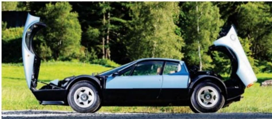
Belle symétrie dans la cinématique d'ouverture des ouvrants. Classique, la cellule centrale habillée d'un pare-brise au galbe travaillé adopte l'acier. Au contraire, les capots sont taillés en matériau composite, pour réduire le poids.
