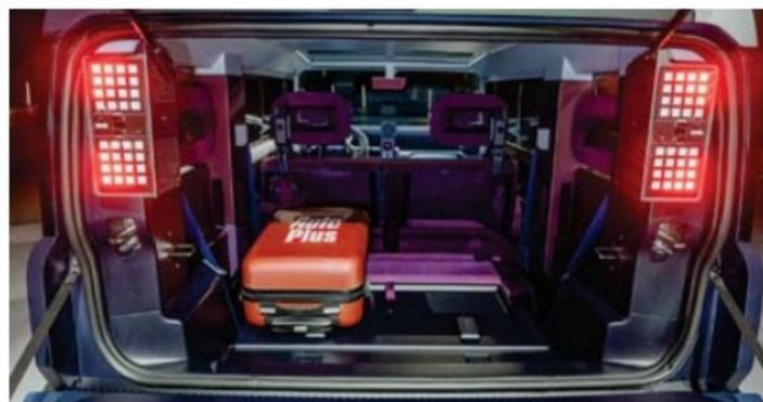
Le coffre s'ouvre en deux parties et offre un volume modulable de 70 à 500 dm<sup>3</sup> (dossiers rabattus). Les feux, placés derrière la vitre, n'ont pas besoin de protection.
