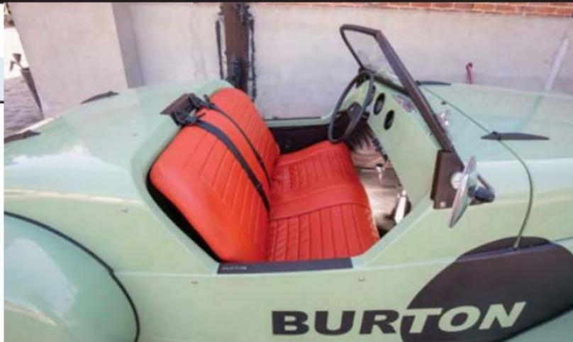
Plutôt accueillante, la banquette en skaï rouge est pourvue de deux ceintures trois points à enrouleurs. Mais elle ne dispose ni d'appui-tête ni de réglages (la position de conduite est fixe !).
