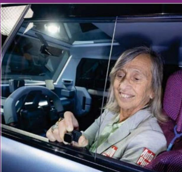
A la manière des 4L d'antan, les vitres coulissent latéralement, évitant tout mécanisme dans les portes. Cela permet de préserver plus d'espace en largeur aux coudes dans l'habitacle.
