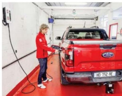
La batterie de 11,9 kWh, intégrée à la benne, offre seulement 32 km d'autonomie électrique. Elle se recharge en 4 h sur Wallbox 3,7 kW, et peut alimenter des appareils extérieurs jusqu'à 6,9 kW.
