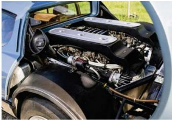
Merveilleux 12 cylindres Boxer, dérivé du moteur de F1 qui gagnera avec Niki Lauda en 1975. Normalement, les culasses sont noires. Admirez au passage les carburateurs triple corps. De redoutables avaleurs de carburant... délicats à régler.
