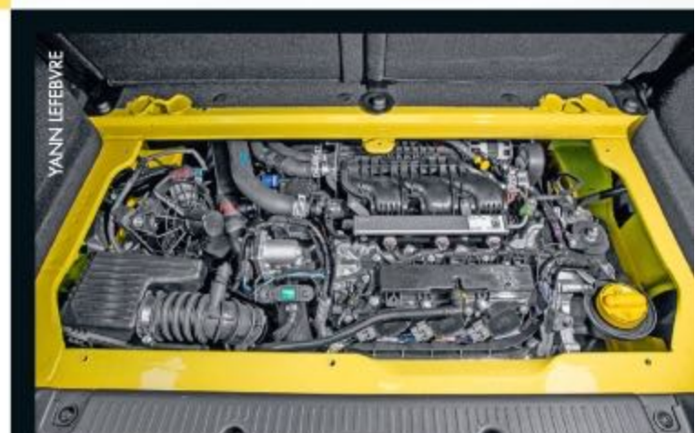
Le 3 cylindres est caché sous le coffre. En matière d'agrément, le TCe 90 ch s'impose sans hésitation.
