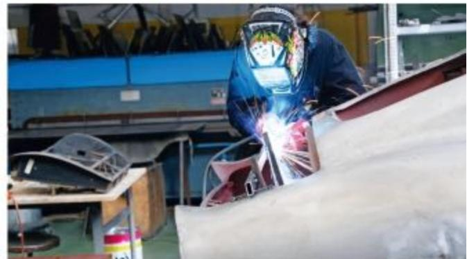
La soudure électrique (MIG) pour assembler les gabarits, le chalumeau pour la tôle extérieure.
