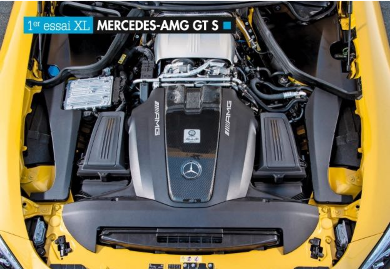
La GT inaugure un V8 biturbo 4 litres à carter sec, placé en position centrale avant. Il est couplé à une boîte à double embrayage, rejetée à l'arrière pour équilibrer les masses.
