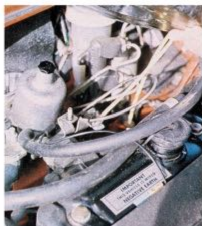
Le carburateur à buse variable semi-inversé est coiffé par le filtre à air annulaire.
