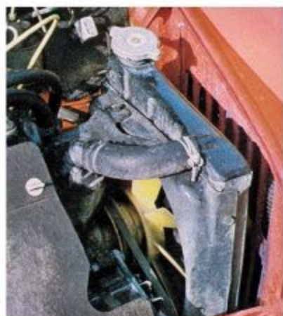
Le radiateur et le ventilateur à pales multiples, assez sonore, sont également placés transversalement.
