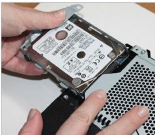
Remplacer le disque dur d'origine de la PS4 par un modèle de plus grande capacité nécessite une mise à jour logicielle de la console.
