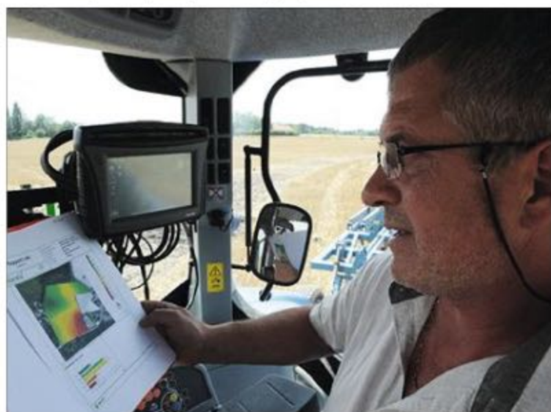
ORDINATEUR DE BORD Les tracteurs sont géolocalisés et guidés par GPS. Des photos infrarouges révèlent les besoins spécifiques pour chaque parcelle.
