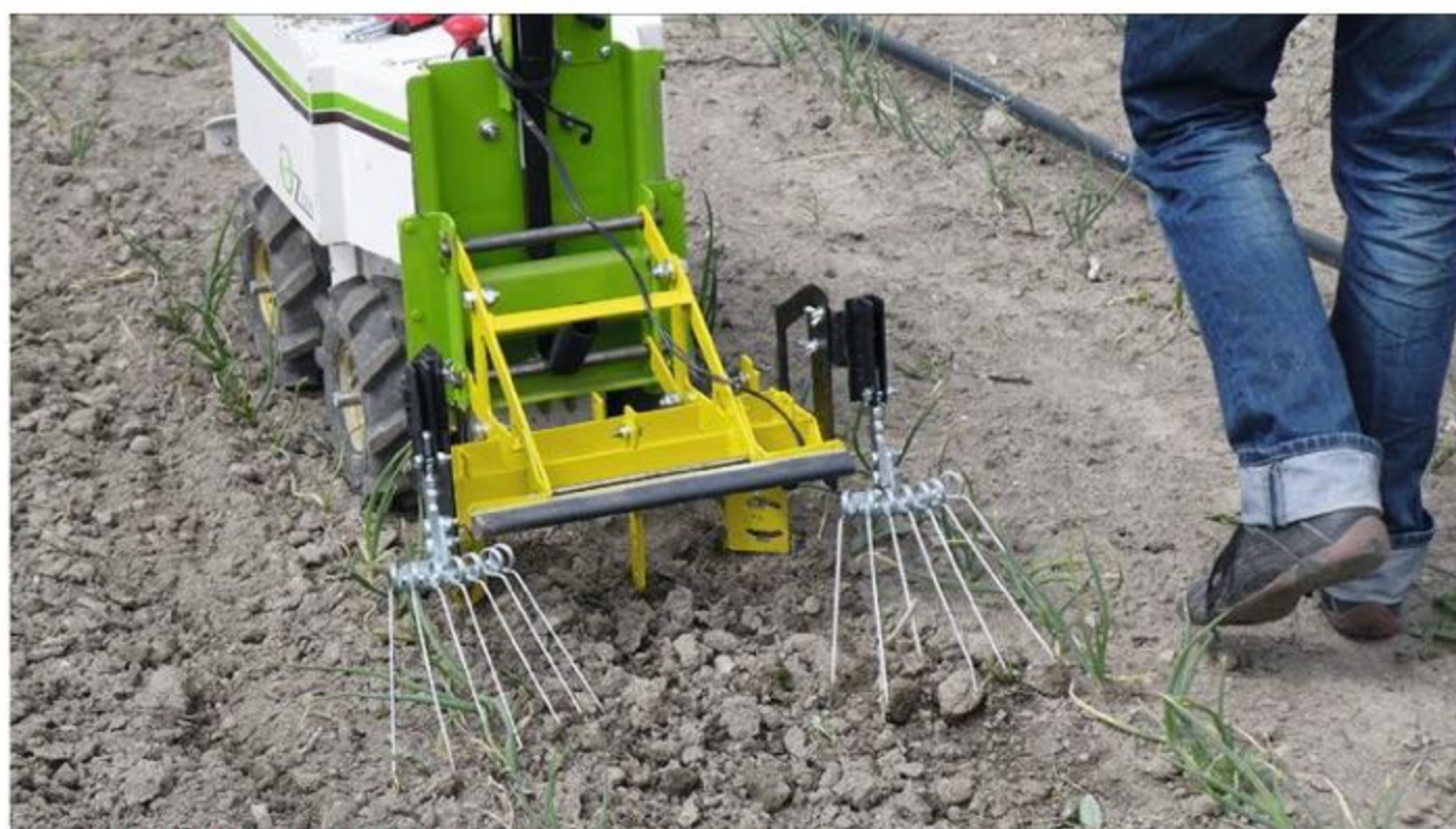
ROBOT DANS LE POTAGER Grâce à Oz, développé par le français Naïo Technologies, les maraîchers le regardent désherber 100 mètres en cinq minutes sans aucune intervention.
