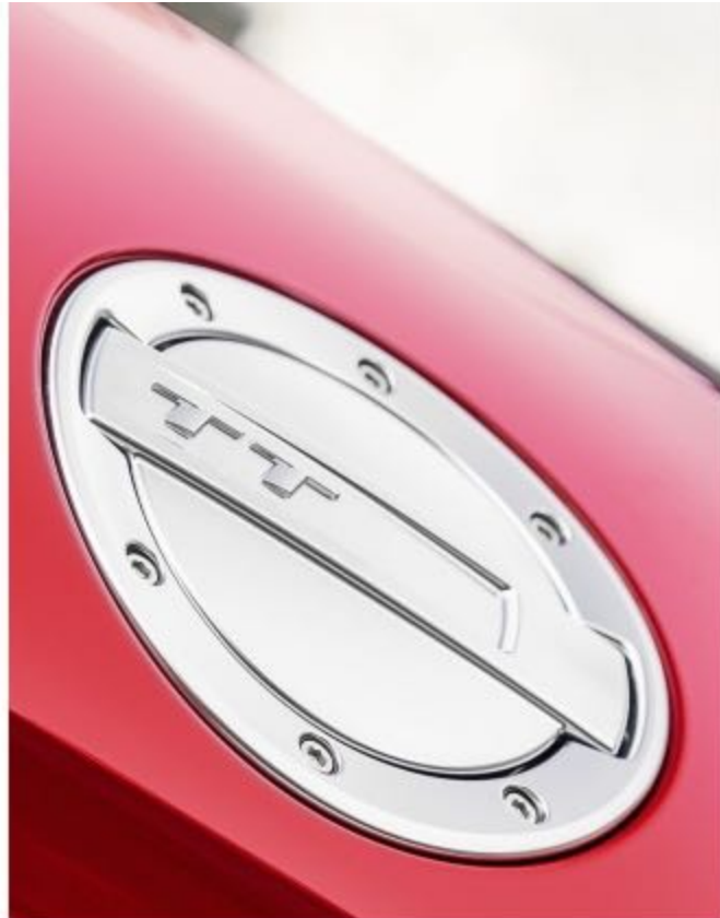
La trappe à carburant aviation bascule. Pas de bouchon de réservoir à dévisser pour faire le plein.
