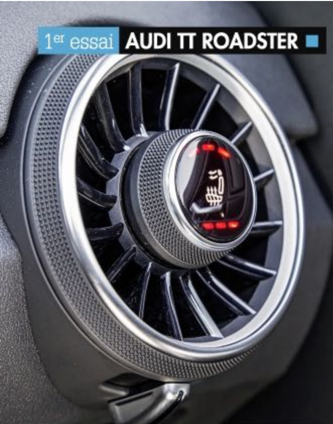
Bien vu, la commande des sièges chauffants est intégrée à la molette de fermeture d'ouïe d'aération.
