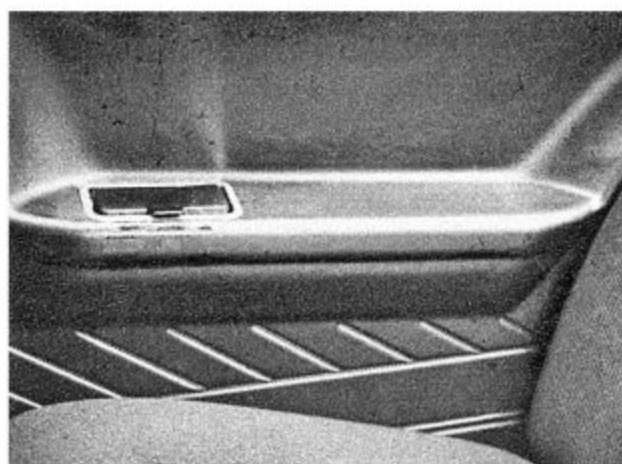
Des   videments augmentent la largeur aux coudes    l'arri  re.
