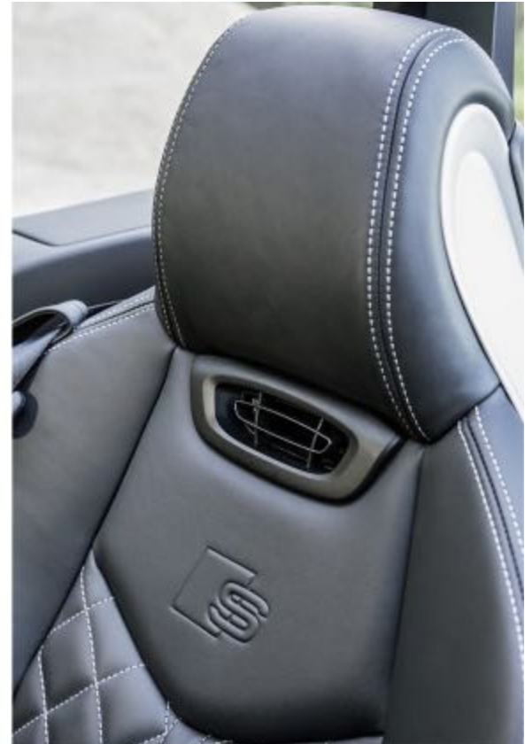
En option sur les sièges sport, des buses d'aération soufflent de l'air chaud sur la nuque.
