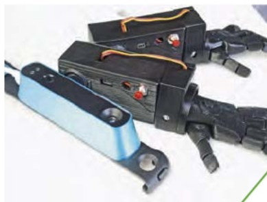
Quelques prototypes d'OpenBionics. À gauche, le Structure Sensor, qui permet aux clients de scanner le bras auquel sera rattachée leur nouvelle main.
