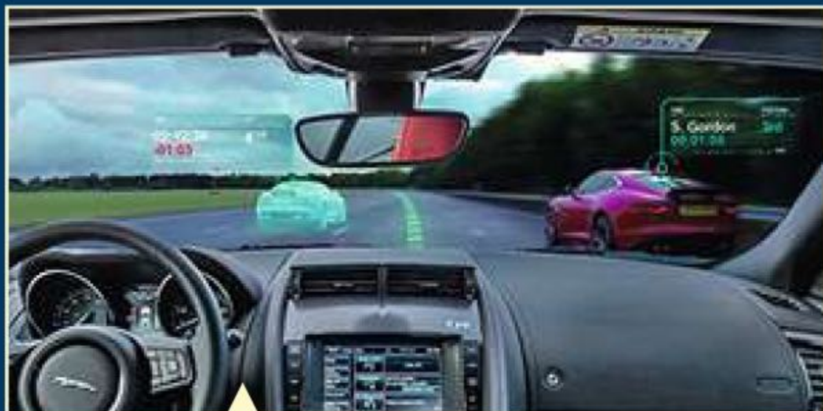
AUTOMOBILE Les systèmes d'affichage tête haute existent déjà sur certains véhicules. Ils projettent sur le pare-brise des infos importantes sans que le conducteur ait à quitter la route des yeux.
