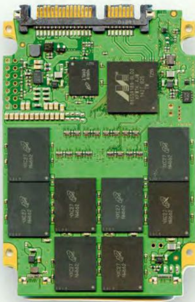
Le MX200 et son contrôleur Marvell 88SS9189 équipé de 1 Go de DDR2.
