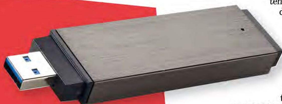
Une clé USB 3.0 qui contient un SSD.
