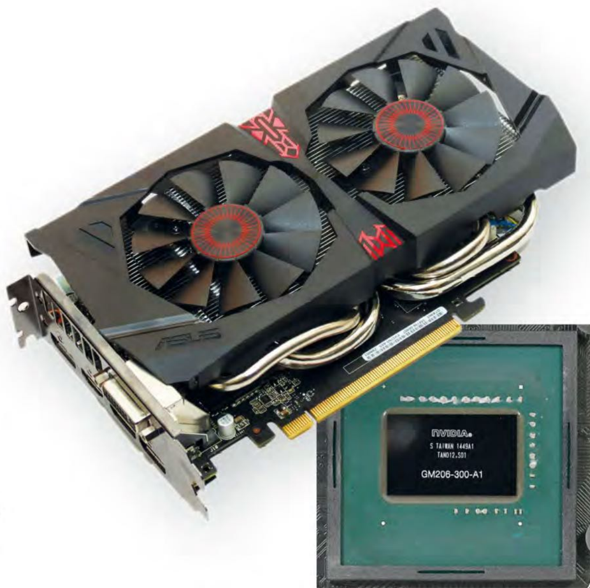
Le GPU GM206 comporte 2,9 milliards de transistors sur 230 mm².
