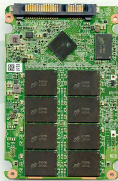
Le BX100 utilise la même flash MLC 16 nm, mais embarque un contrôleur SM2246EN de Silicon Motion et 1 Go de DDR3.
