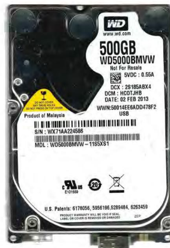
Ce disque dur 2.5" trouvé dans un boîtier externe comporte directement un port USB.
