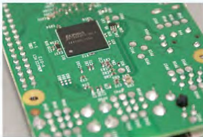
La puce de DDR2 (1 Go), maintenant placée sous la carte.
