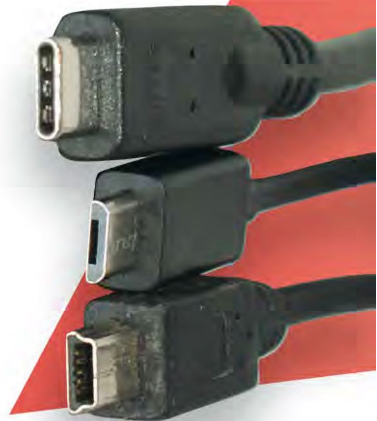
Trois prises USB : Type C, Micro-B 2.0 et Mini-B.
