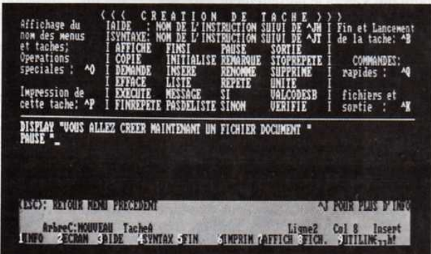
Pour créer la tâche, on dispose de 24 mots-clés. Chaque tâche est rattachée à un menu.
