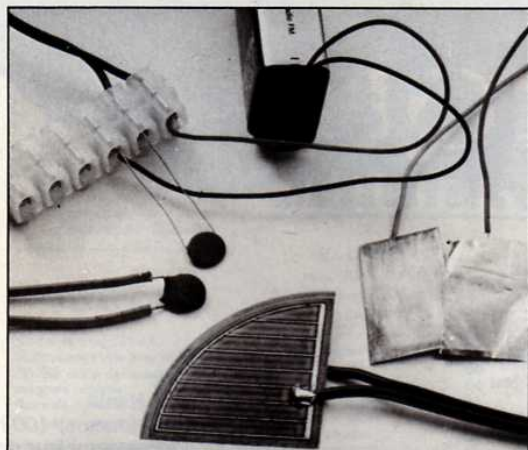
Toutes sortes de circuits peuvent être connectés à la carte CS 3600. Dans le sens des aiguilles d'une montre : thermistance, photo-résistance, pile expérimentale cuivre-zinc, photo-pile.
