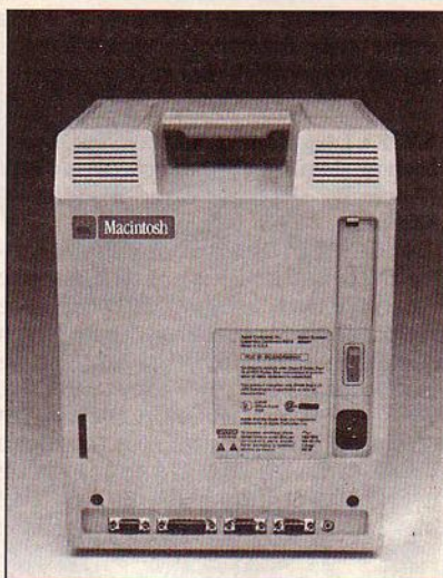
Les connecteurs (de gauche à droite) : souris, lecteur de disquettes externe, 2 sorties RS 232 C ou RS 422, son. La fente reçoit une chaîne anti-vol. En haut à droite, logement des piles de l'horloge.
