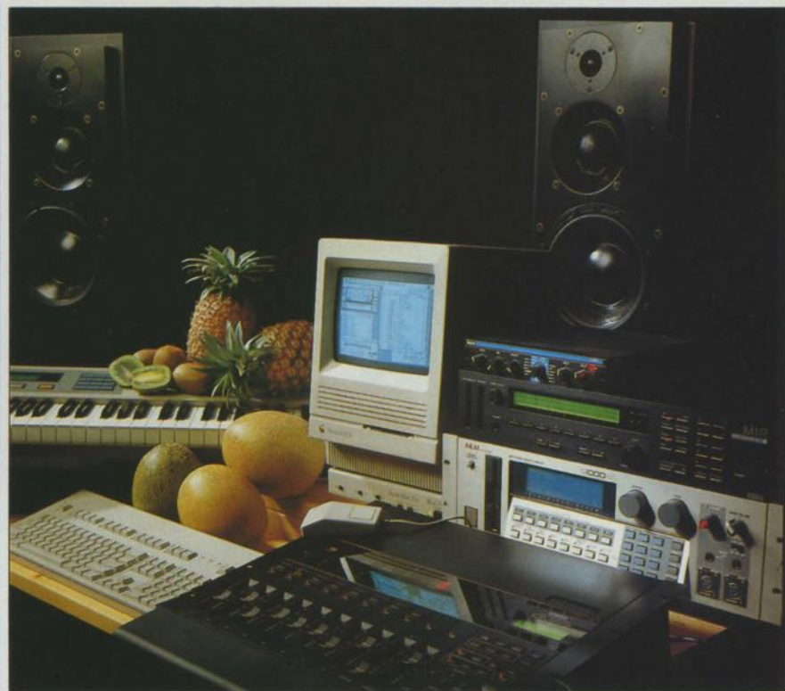
Un studio personnel professionnel : Macintosh SE/30 avec 4 Mo de mémoire vive et disque dur interne de 40 Mo, interface MIDI Studio Plus 2, logiciel Performer 2.41, clavier maître Akai MX76, expandeur Korg M1R, échantillonneur Akai S1000 HD, console DMP7, réverbération Lexicon LXP1. Total : environ 150 000 F.
