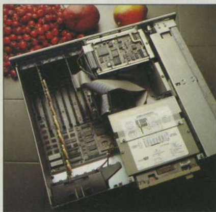
La taille du coffret du 386/33 autorise six connecteurs d'extension.
