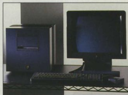
Le Next est un cube noir de 30 cm de côté. Au premier plan, l'écran de 17 pouces de diagonale.
