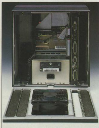
A l'intérieur du Next, toute l'électronique est regroupée sur une seule carte, laissant la place pour trois cartes d'extension.
