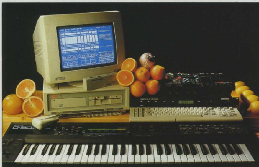
Un studio personnel milieu de gamme : Amstrad PC 1640 avec disque dur 20 Mo, interface MIDI MPU-ITC-P et logiciel Séquence 1000 de Fretless, synthétiseur D50, expandeur Proteus et magnéto 4 pistes à cassettes Fostex X30. Total : environ 34 000 F.
