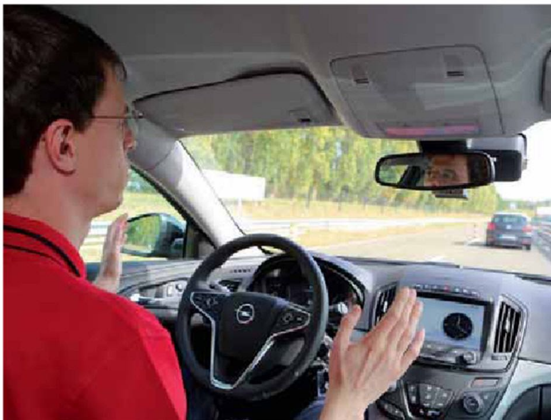
Les systèmes TRW équipant ce véhicule le guident sur sa voie et, le cas échéant, activent le freinage. L'équipementier a démontré un système opérant si besoin une manœuvre d'évitement automatique à 80 km/h sur circuit. Son utilisation en conditions réelles de circulation est encore impossible.
