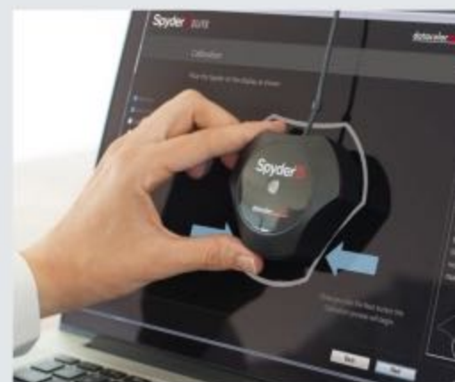
Calibrage à l'aide d'une sonde Spyder 5Elite.
