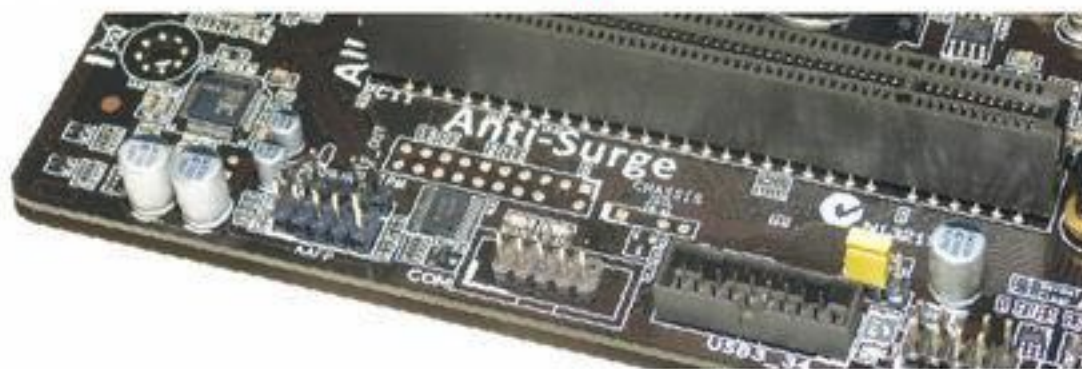
Un connecteur pour un port COM externe.
