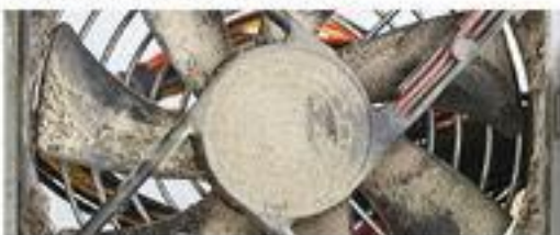
Sale, un ventilateur devient vite bruyant !
