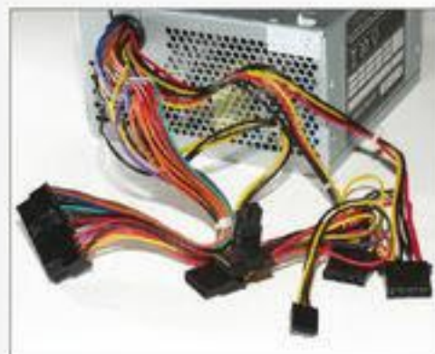
Une alimentation bas de gamme qui ne propose pas de connecteur SATA ni PCI Express.
