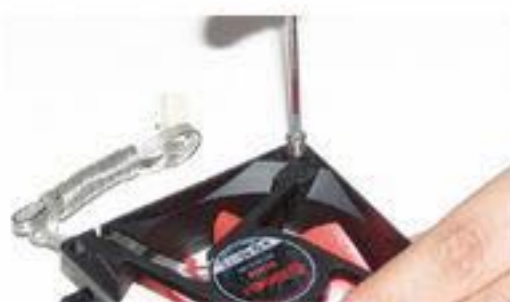
Quand on insère une vis autotaraudeuse, il faut exercer une poussée verticale.
