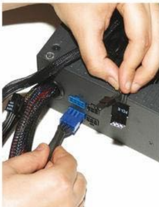
Ne connectez que les câbles dont vous avez besoin avec une alimentation modulaire.
