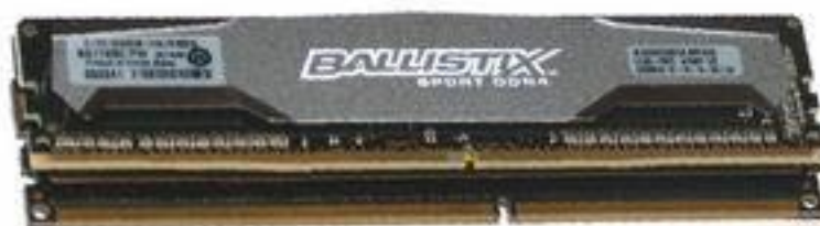
Une barrette de mémoire DDR4 sur une barrette de DDR3 ; on peut noter la forme qui est courbée sur la plus récente des deux.
