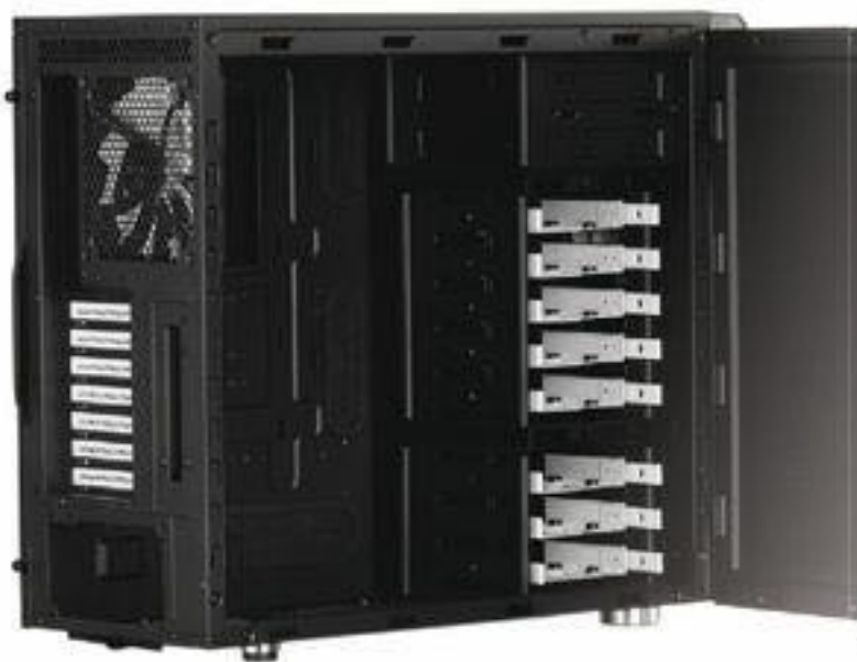
L'intérieur du Fractal Design Define R4 montre que les possibilités de rangement sont nombreuses.
