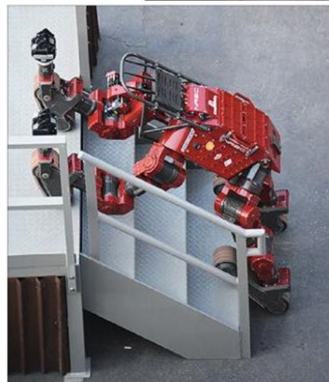
Chimp s'est mis sur ses quatre pattes dotées de chenilles pour grimper l'escalier, mais il a glissé deux fois !
