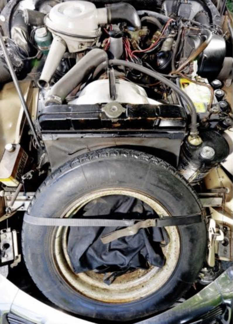
En ouvrant le capot, on tombe nez à nez avec la roue de secours. Le moteur est relégué au fond.
