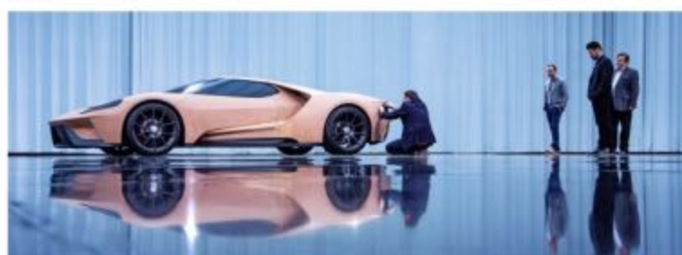
Les premières maquettes ont été réalisées en polystyrène, avant de passer à ce modèle traditionnel en clay.
