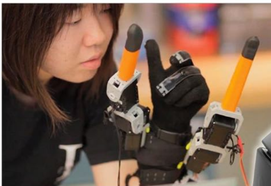
LA MAIN À SEPT DOIGTS Conçus au MIT, ces deux doigts robotisés s'ajoutent à ceux de notre main pour effectuer de nouvelles tâches, comme tenir une tasse et touiller avec une cuillère en même temps.
