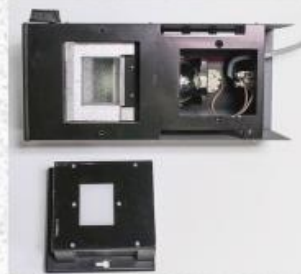
DIFFUSEUR : Le Durst 670 VC possède une tête contraste variable à éclairage diffus. La tête démontée montre l'emplacement de l'ampoule basse tension et l'élément diffusant amovible. Le schéma décrit le chemin du flux lumineux.
