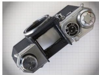
Les premiers reflex 24x36 étaient des "téléométriques modifiés". Le boîtier possédait souvent une excroissance destinée à supporter la baïonnette, afin de laisser de la place pour le miroir à 45° à l'intérieur de la chambre.
