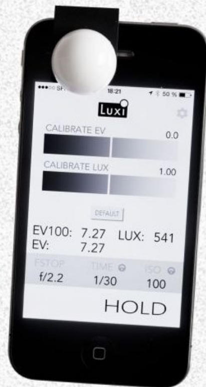
Pincé sur un iPhone 4, l'accessoire de mesure de lumière incidente est couplé avec l'application Luxi.
