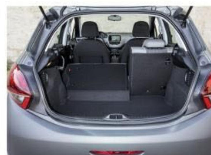
Le coffre de la 208 propose un volume de 332 dm<sup>3</sup>, une valeur supérieure à la moyenne de la catégorie (307 dm<sup>3</sup>).
