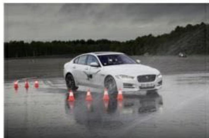
Toujours sur sol humide, ce test consiste à lever brutalement le pied de l'accélérateur en virage. Durant le test, la XE décroche à 55 km/h, ce qui est un très bon résultat. Tout se passe en douceur et progressivité, avec un sous-virage contenu et un léger survirage facilement maîtrisé. Les garde-fous électroniques sont efficaces.
