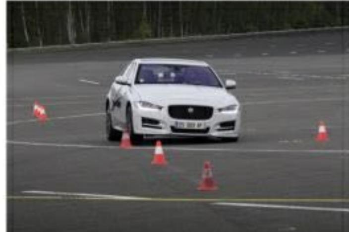
Ce test reproduit un brusque changement de file. Il est effectué entre 100 km/h et 120 km/h. Test passé jusqu'à 100 km/h avec grande aisance, plus compliqué ensuite. À 110 km/h, la XE manifeste une tendance avérée au survirage dès l'inscription, tendance qui va croissant jusqu'à la sortie et réclame un certain doigté pour réussir l'épreuve. Échec ensuite lors de la tentative à 120 km/h. **VERDICT ■**
