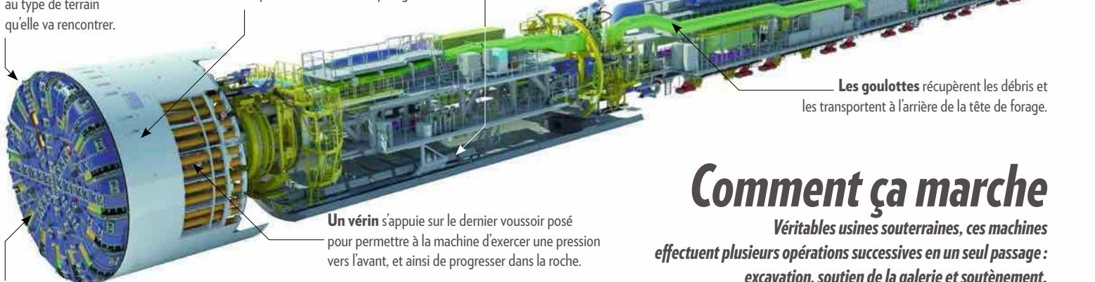
**Les molettes** tournent en même temps que la roue de coupe, sous une pression pouvant dépasser les 27 tonnes, afin d'éclater la roche. Sur les machines les plus récentes, elles sont équipées de capteurs qui analysent en temps réel la qualité de la roche et détectent les obstacles éventuels, afin que le tunnelier puisse adapter sa pression.
