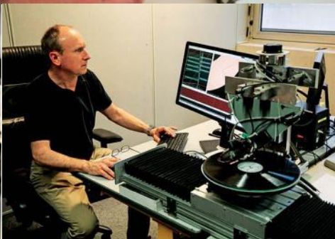
La dilatation de la cellulose ayant réduit le disque en morceaux, une platine et un ordinateur permettront de reconstituer le puzzle.
